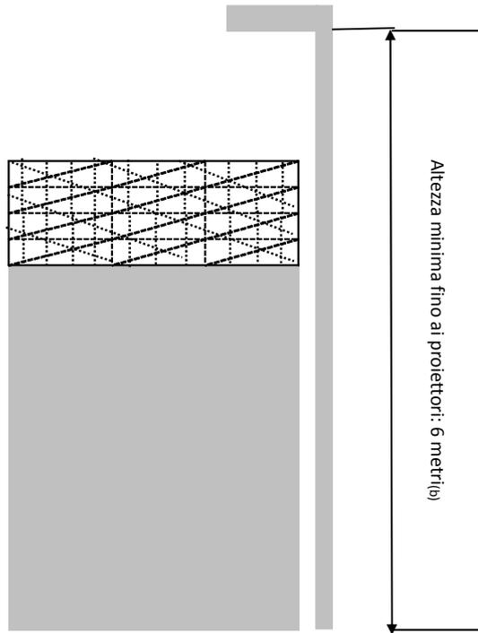
(b) Si raccomanda l'asse longitudinale del campo negli impianti all'aperto sia N-S, ammettendosi una variabilità compresa tra N-NE e N-NO
